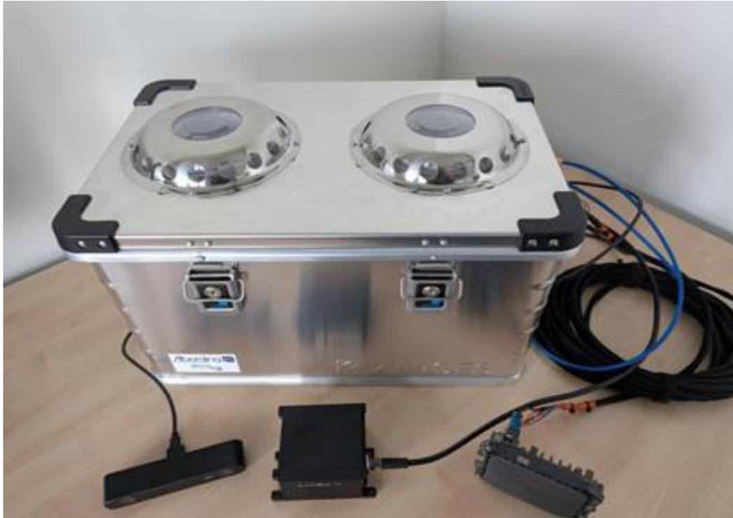
Sensorbox mit angeschlossenen Sensoren
